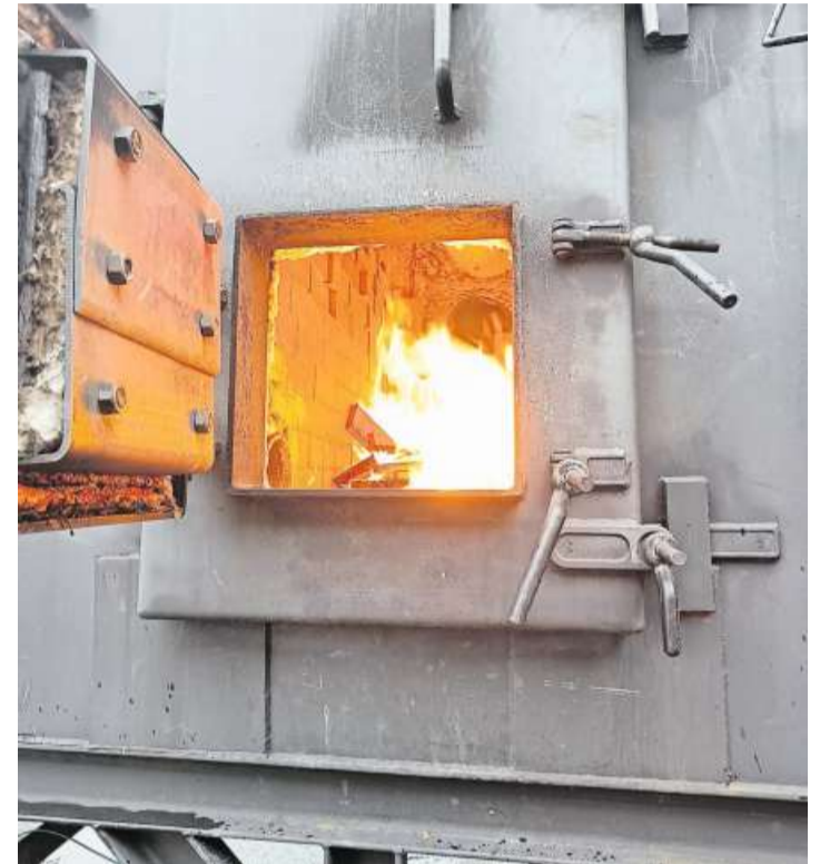
Etwa fünf Stunden lang müssen die beiden Köhler einfeuern, anschliessend erhält das austretende Holzgas die Hitze aufrecht.
